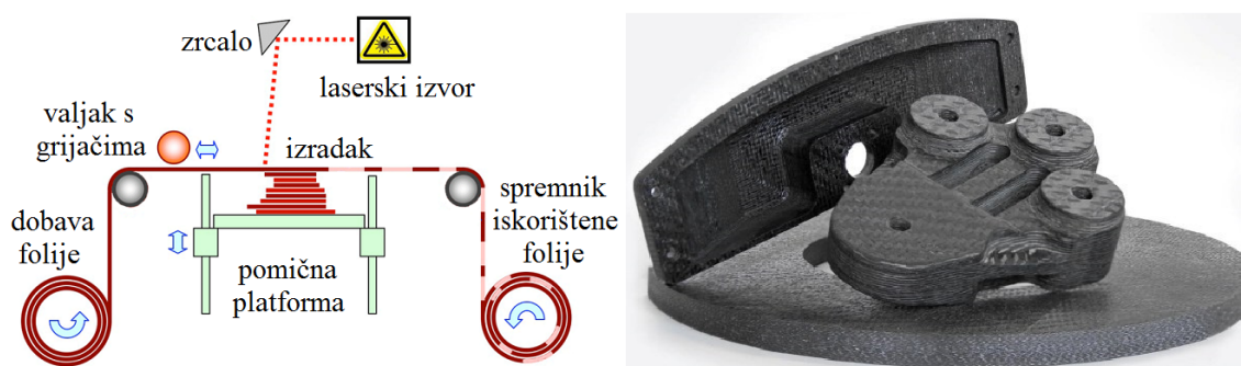
Slika 57. Shematski prikaz laminiranja popraćen primjerom
