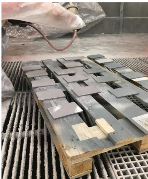
Slika 35 Nanošenje premaza na uzorke zračnim prskanjem
