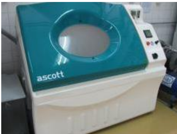
Slika 38: Slana komora Ascott S450, Laboratorij za zaštitu materijala, FSB
