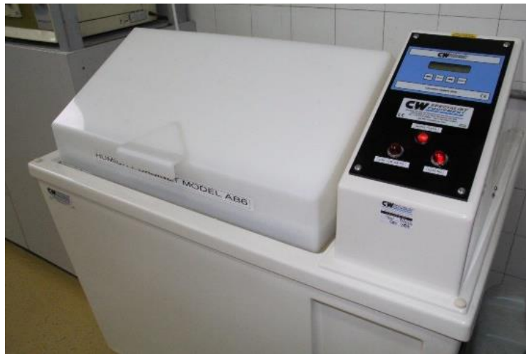
Slika 41 Vlažna komora C&W, Model AB6, Laboratorij za zaštitu materijala, FSB
