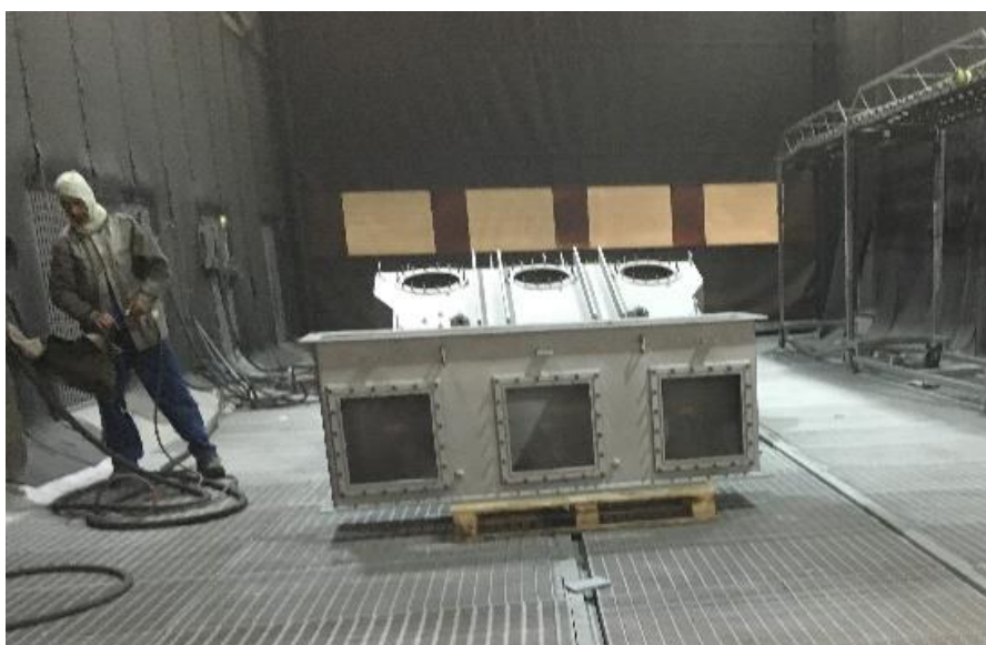
Slika 29 Kabina za pjeskarenje te uzorak za pjeskarenje, Končar MK
