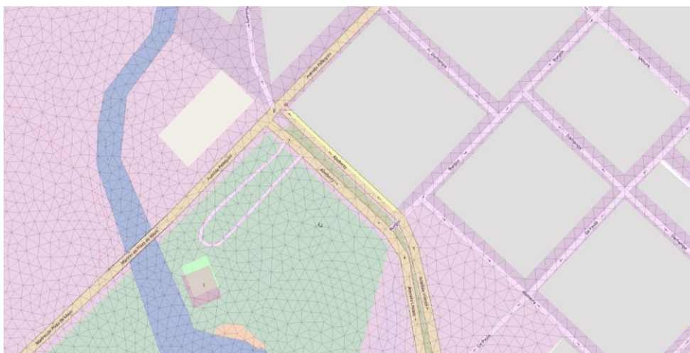
Figura 3.: Malla de TIN en una parte del dominio, con huecos para las manzanas de la ciudad, realizada con el mallador Gmsh para QGIS.
