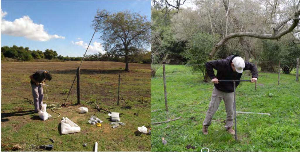
Figura 4.1: Realización de perforaciones someras mediante barreno manual.
