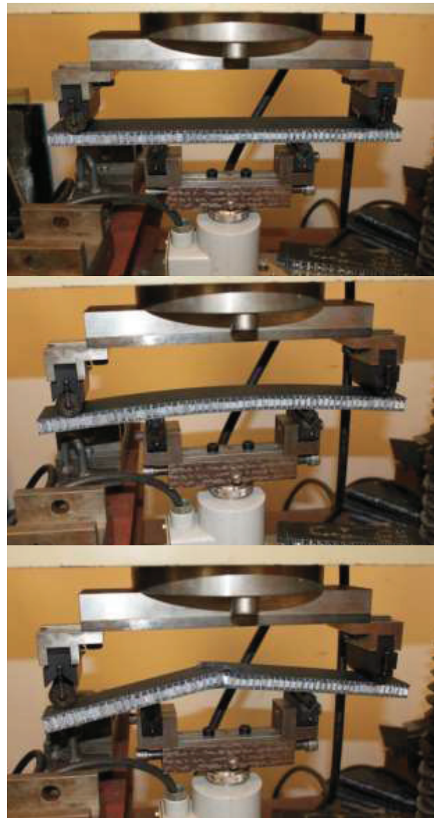
2. ábra - Próbatest konfiguráció a hajlítási teszthez
