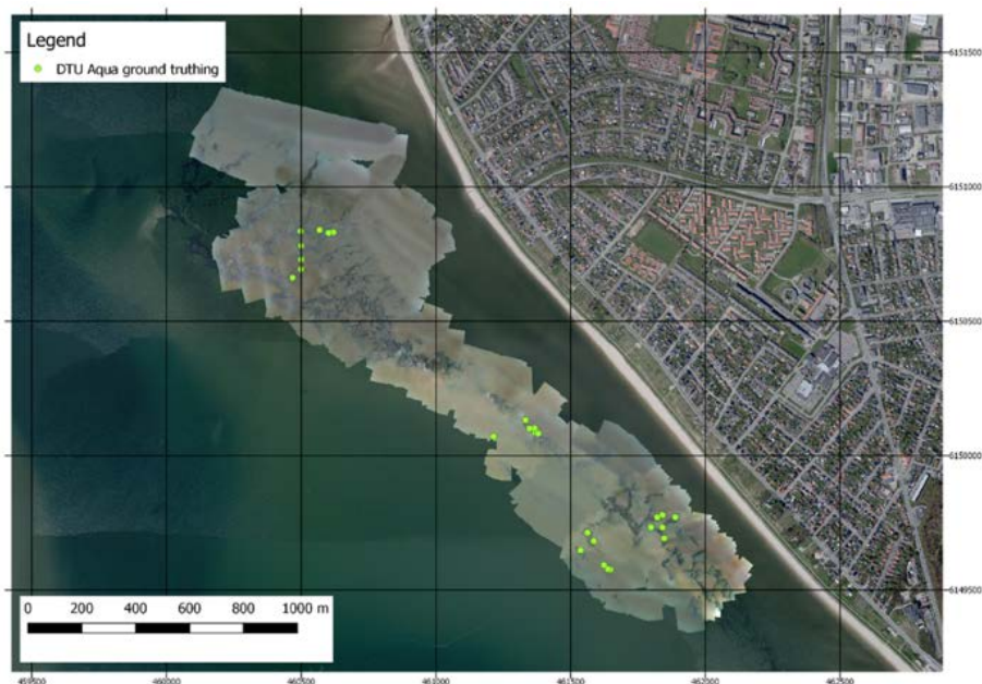
Figur 5. Orthorecteret og georefereret RGB kort af litorale muslingebanker ud for Sædding Strand i 2017 med drone. De grønne punkter viser hvor, der er indsamlet rammeprøver.
