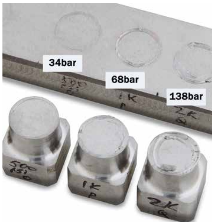
Rivningsresultater på ikke-hærdet 316-materiale viser tydelig rivning ved relativt lavt tryk.
