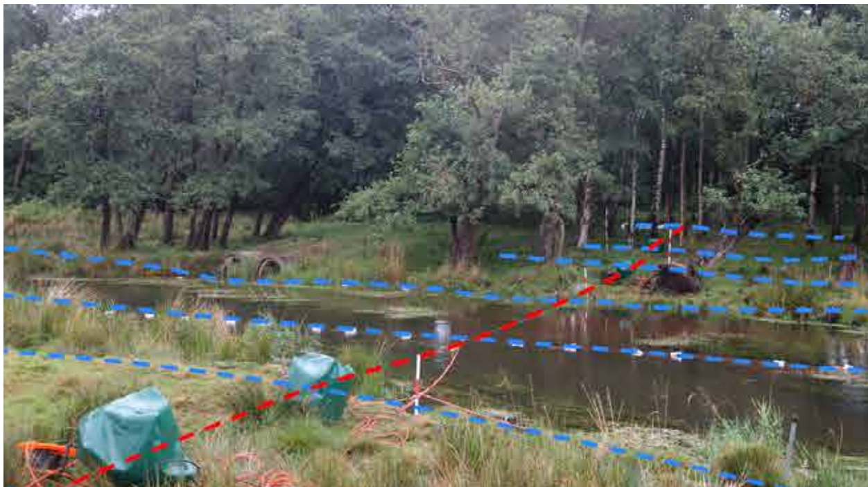
FIGUR 6 3D DCIP-MÅLINGER MED ELEKTRODER FLYDENDE I GRINDSTED Å.
