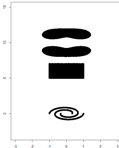
FIGURE 5.2 – Illustration des trois répartitions différentes sur lesquelles on applique Ballsterning afin de voir l’impact de la répartition des données sur le temps d’exécution. De haut en bas : Cassini, uniforme et spirale.
