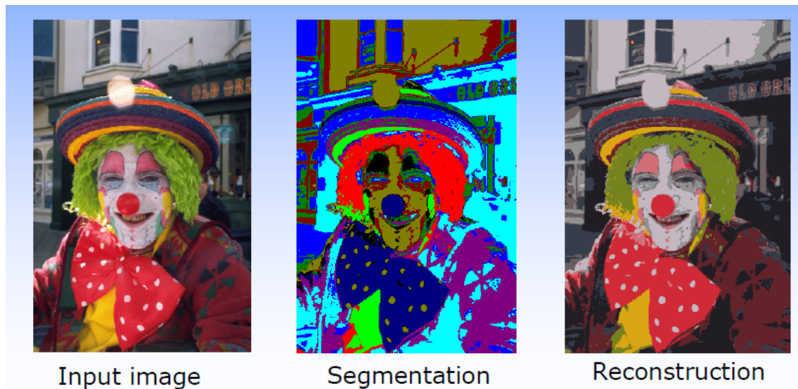
FIGURE 1.2 – Segmentation d’image effectuée grâce au clustering. De gauche à droite : la photo initiale, la mise en évidence des partitions obtenues via segmentation, et enfin l’image compressée.
