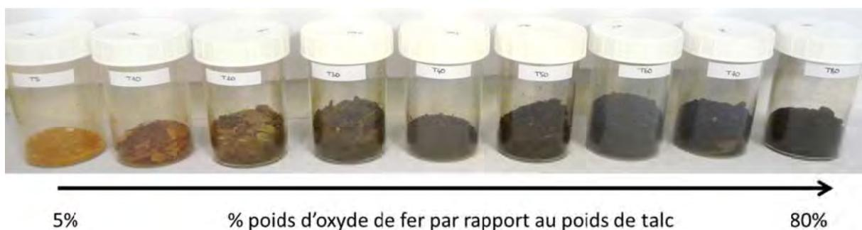
**Figure 28** Gamme de talcs synthétiques magnétiques à température ambiante
