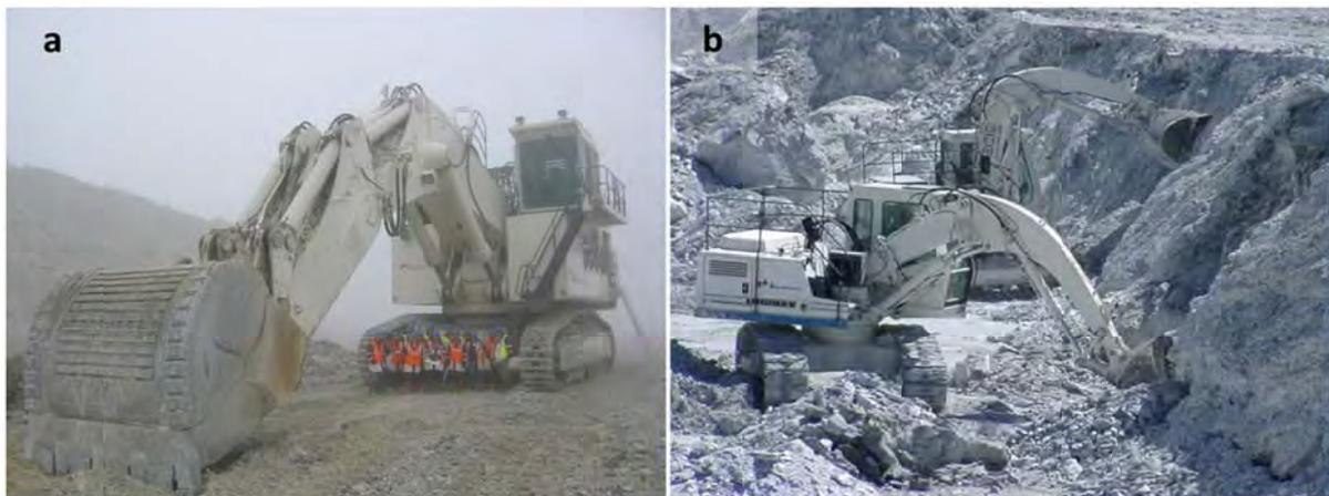
**Figure 8** Pelles mécaniques hydrauliques utilisées sur le gisement pour (a) la découverte et (b) pour l'extraction
