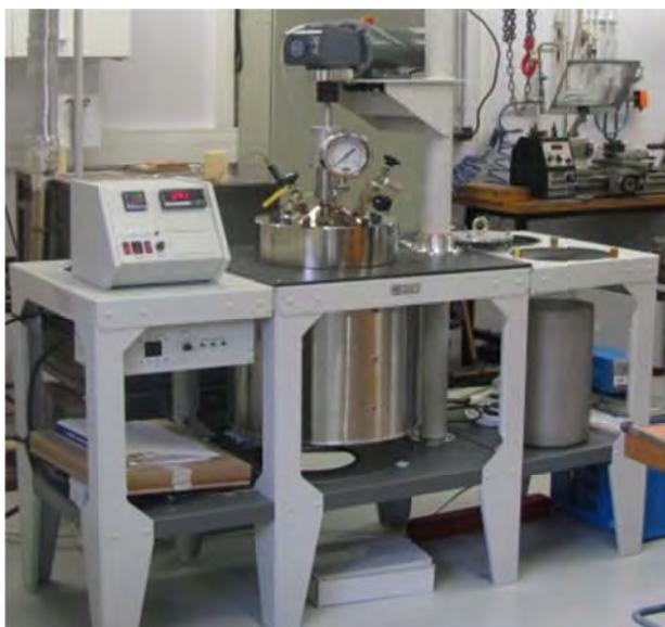
**Figure 4** Autoclave de 20 litres en inox disponible au GET (PARR INSTRUMENT COMPANY)
