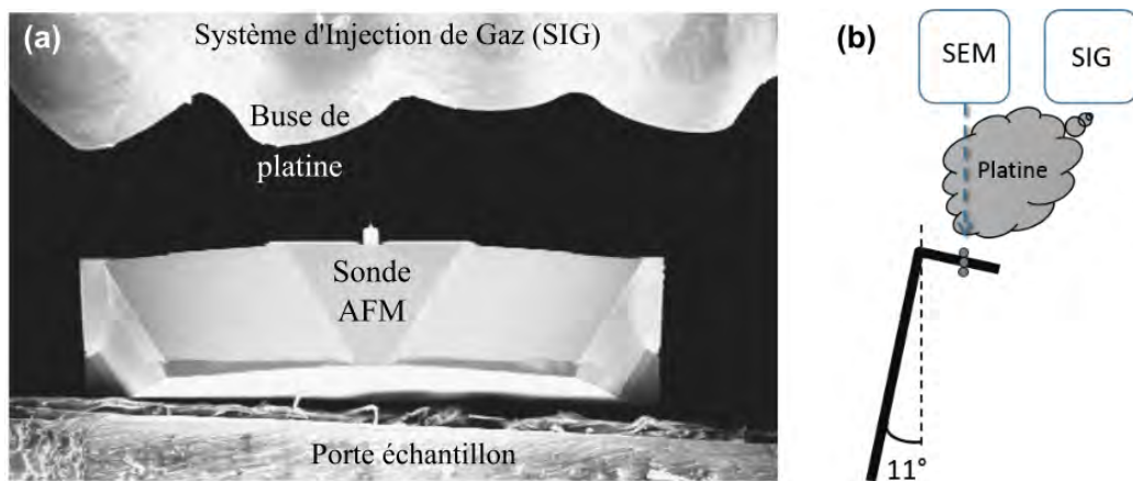
Figure 8.7 – Images SEM d’une sonde AFM OLTESPA-R3 positionnée devant le Système d’Injection de Gaz (SIG) du FIB. (b) Représentation schématique du protocole de dépôt des défauts topographiques.
