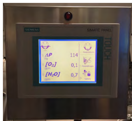
FIGURE 3.10 – Ecran de contrôle de l'oxygène, de l'humidité et de la pression à l'intérieur de la boîte à gants.
