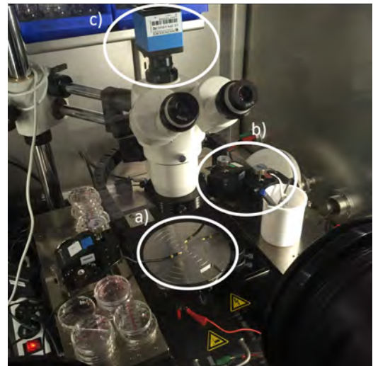
FIGURE 3.20 – Photographie de la station sous pointes. a) pointes, b) micro-positionneurs et c) caméra.
