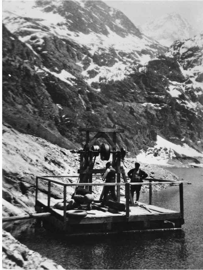
Fig. 14. Radeau des expériences du lac d'Oô, permettant d'utiliser des profondeurs de 80 mètres [19].
