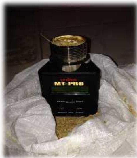
Medidor de humedad
