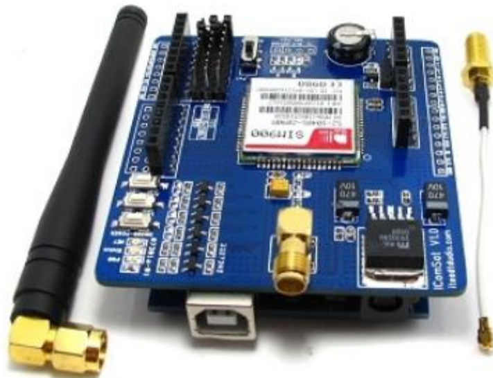
Figura 22. Módulo SIM900 GSM/GPRS. Fuente: CrCibernética.
