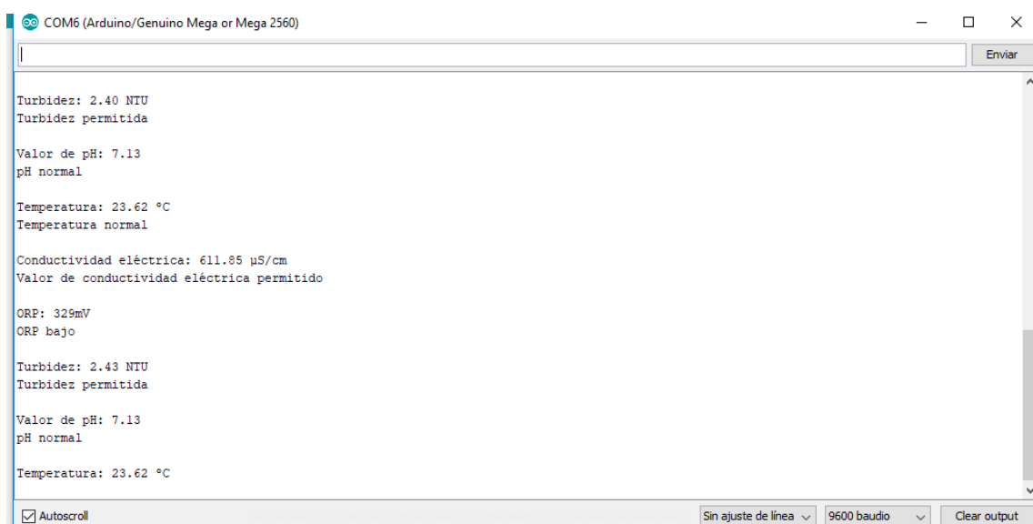
Figura 34. Mediciones simultáneas de ph, temperatura, conductividad eléctrica, ORP y turbidez en agua de grifo.
