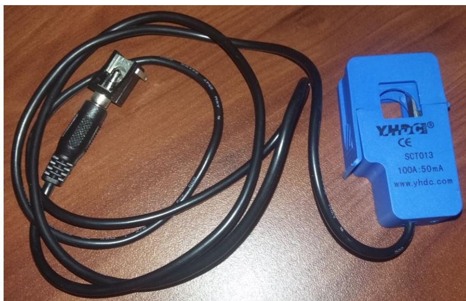
Figura 38. Sensor de corriente para simular la corriente que circula por la bomba sumergible
