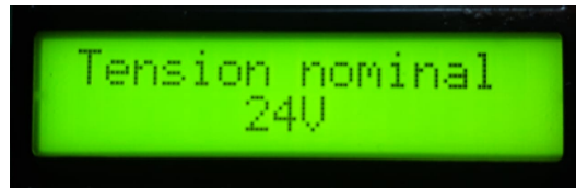
Figura 5.5: Pantalla mostrando configuración para tensión nominal de 24V .
