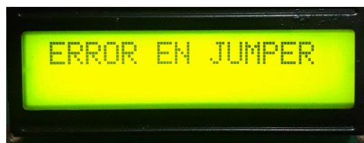
Figura 5.6: Pantalla mostrando error en configuración de tensión nominal.
