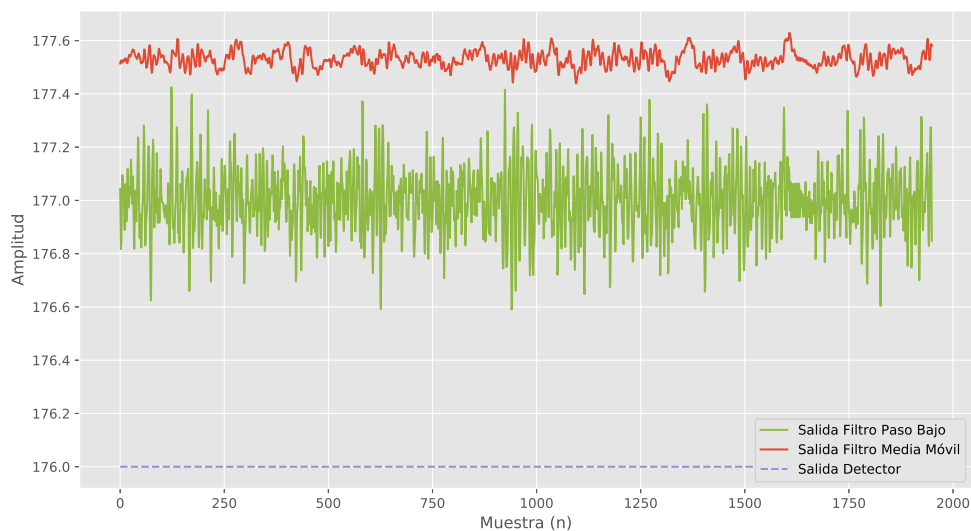
Figura 5.15: Salida de los filtros paso bajo y de media móvil, junto a la salida del detector, al utilizar una señal de ruido para probar la eficacia del sistema.
