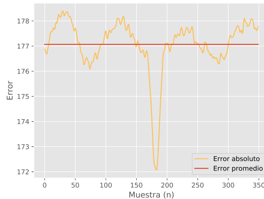
Figura 5.13: Error en la correlación de una señal ECG contra su respectivo patrón, caso 1.
