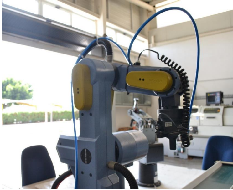
Figura 5.3. En azul el cable neumático, que va desde la base hasta la muñeca
