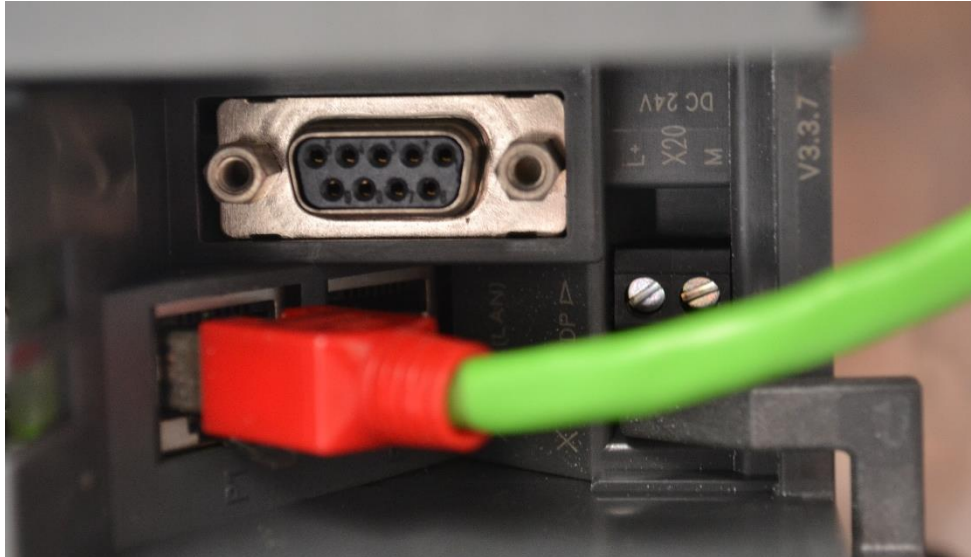
Figura 5.12. Comunicación entre HMI y PLC
