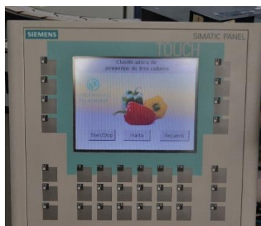
Figura 3.10. Panel Siemens HMI OP 177B
