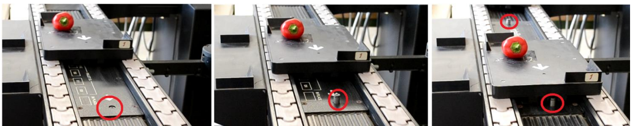
Figura 3.4. Pistones de parada de cajas de entrada, con los pistones de parada señalados
