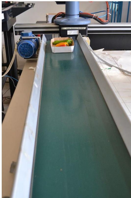
Figura 3.6. Cinta secundaria, al fondo motor monofásico
