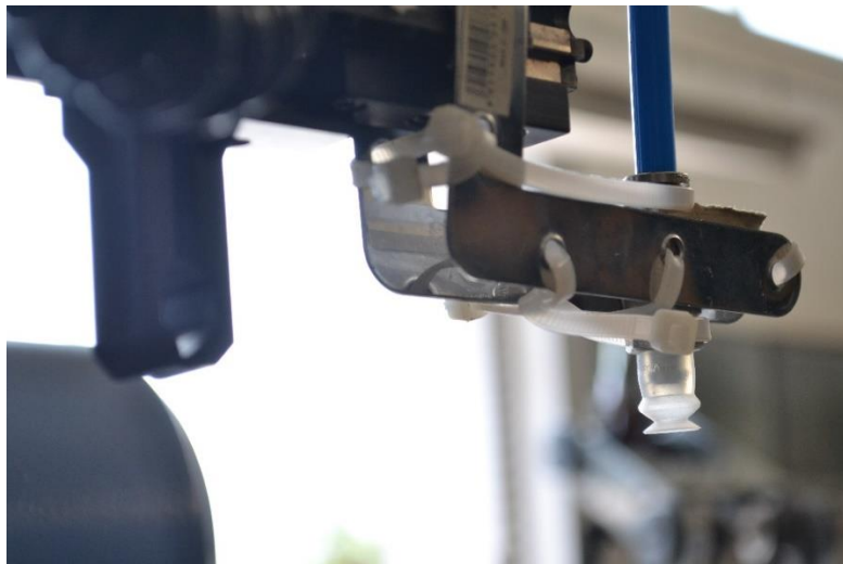
Figura 5.4. Elemento terminal finalizado (ventosa)
