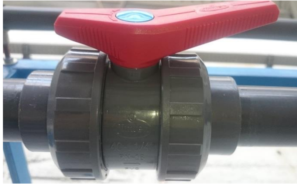
Figura 2-11 Gráfica de pérdidas de carga vs caudal para distintas aperturas de la válvula (imagen izquierda) y válvula esférica usada para la experimentación en el banco de ensayo
