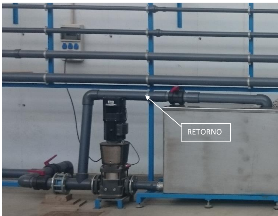
Figura 2-2 Circuito de retorno para regulación de flujo en el banco de ensayo
