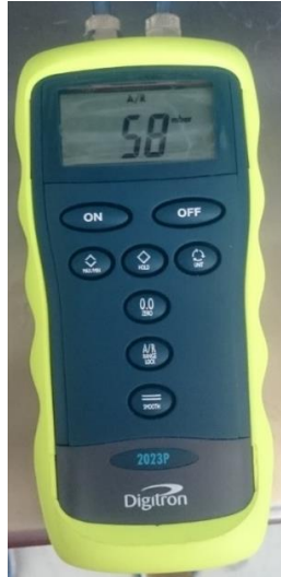
Figura 2-7 Manómetro diferencial digital usado para las mediciones
