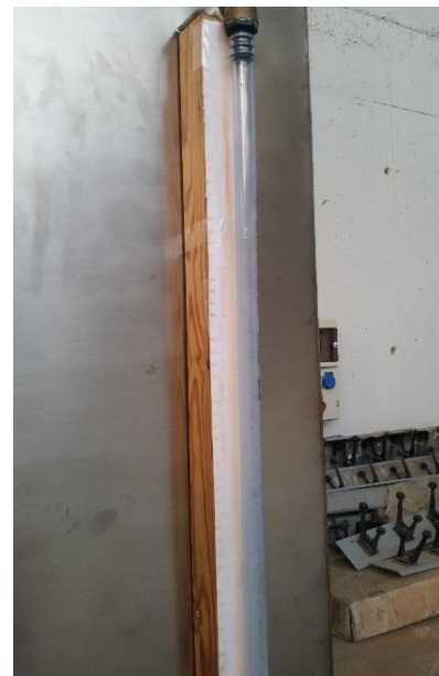
Figura 3-1 Visor del nivel de fluido del tanque volumétrico y escala métrica para cuantificar la altura de fluido introducido
