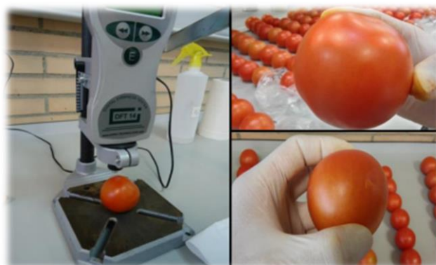
Figura 15. Penetrómetro modelo PENEFEL DFT14 Digital Firmnesstester. Agrotechnologie e incisiones realizadas sobre el fruto para obtener el valor de firmeza.
