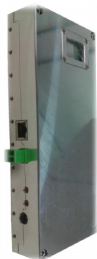
Figura 5.7: Vista frontal del detector WARMPix. En la foto se puede ver la ventana que incluye el módulo Medipix.
