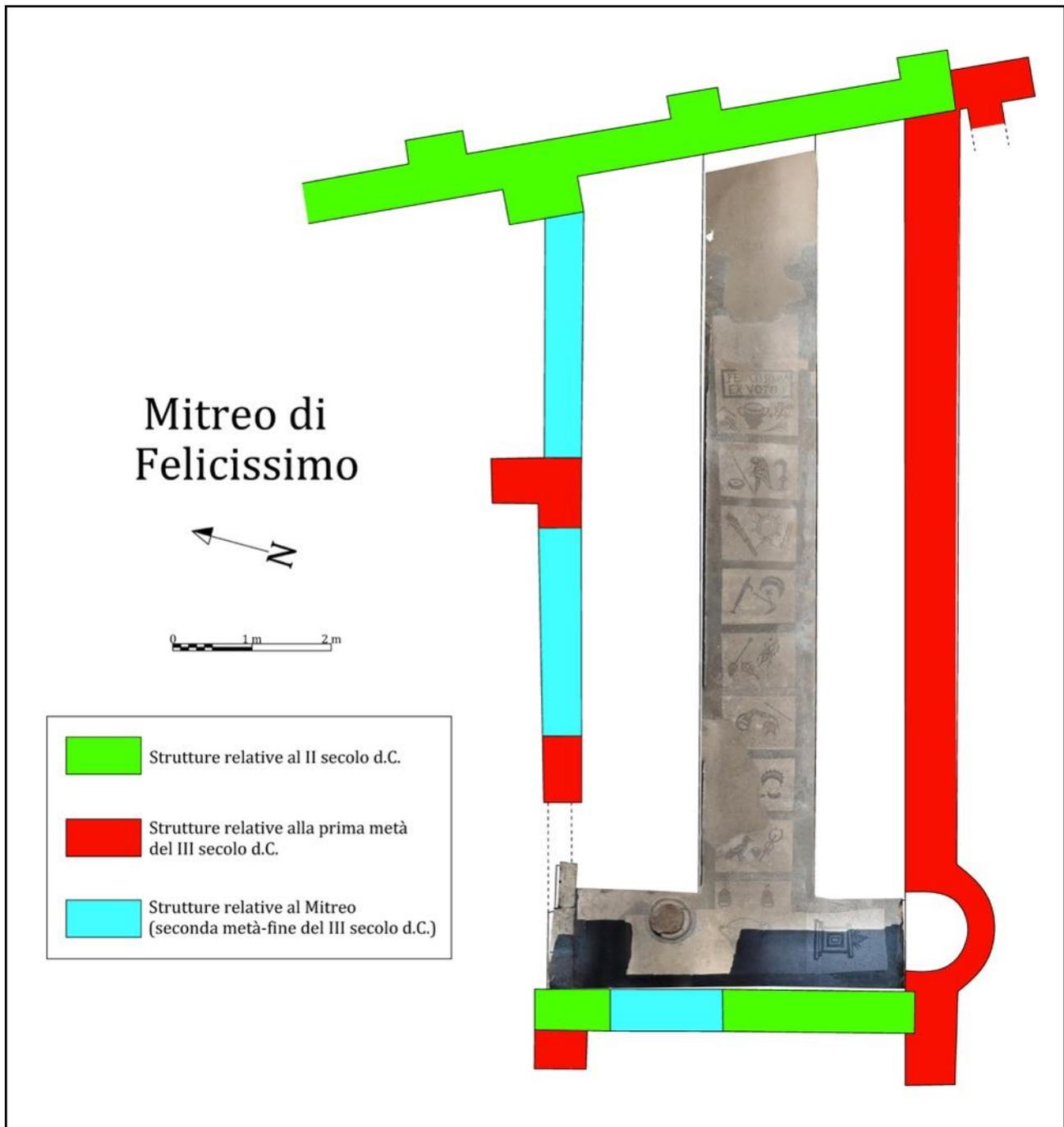
Rilievo dello *spelaeum* del Mitreo di Felicissimo allo stato attuale (rilievo ed elab. A. Melega).
