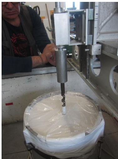
Figura 3.5.3: Realizzazione de preforo per l'infissione del palo.
