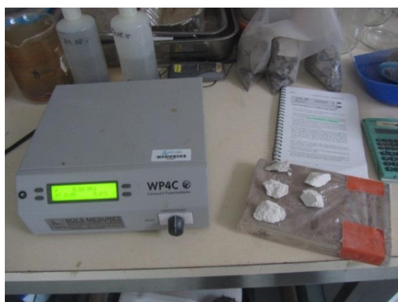
Figura 3.2.8: WP4C per la misura di suzione.
