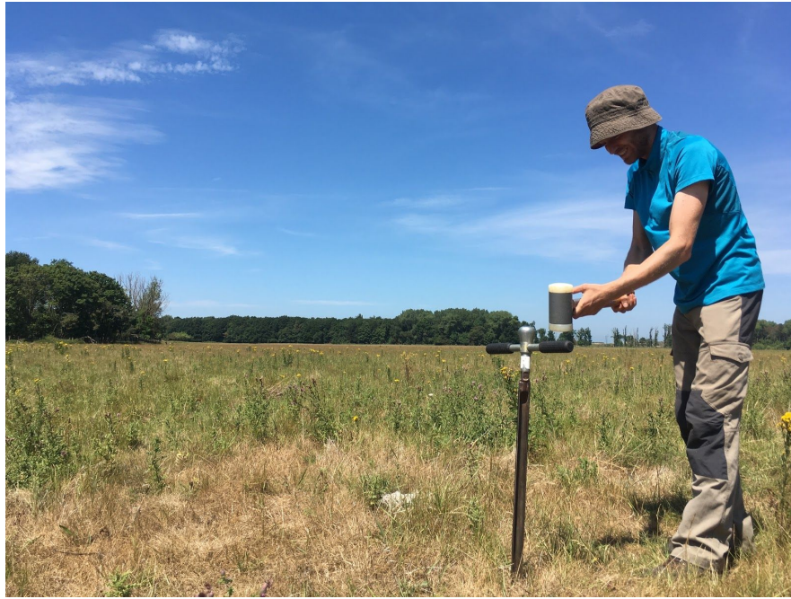
Figuur 3.12: Verzamelen van bodemstalen met gutsboor (Robbe De Beelde van UGent)
