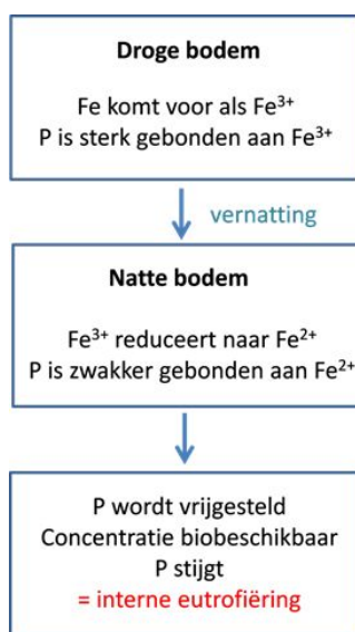
Figuur 2.9: Na vernatting van voormalige landbouwgrond treedt vaak eutrofiëring op door vrijstelling van fosfaat na reductie van \text{Fe}^{3+} naar \text{Fe}^{2+}
