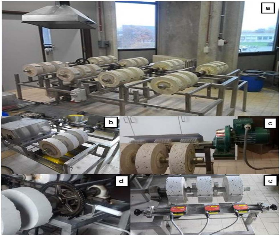
**Figura 1.** Equipo de ensayo de degradación ácida acelerada
