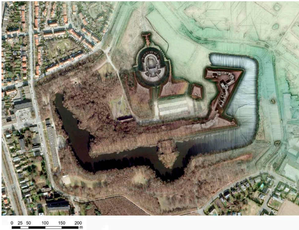
Beeldmontage van Fort 5 in Edegem. De vormen van het fort zijn op het lidarbeeld (rechts) duidelijk af te lezen terwijl de luchtfoto op de linkerhelft een volledig bebost fort toont.
