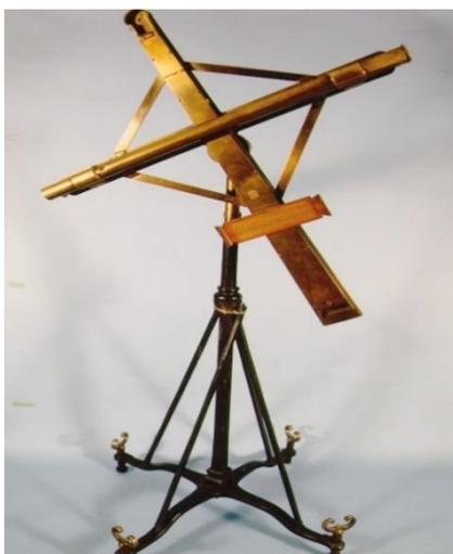
Nivel Geodésico S.XVIII (MNM- Inv. 787). Utilizado en la medición del arco del meridiano.
