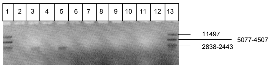
Figuur V.2: Resultaat van de PCR reactie waarbij het fragment tussen het agp1 en het agp3 gen geamplificeerd werd. 1, 13 = \lambda PstI-merker; 3, 5 = amplificatie producten van de reacties met als template het DNA van de \lambda kloons 4.2 en 8.3 respectievelijk. In beide gevallen werd een fragment van ongeveer 2.5 kb geamplificeerd. 7 = resultaat PCR reactie met als template het DNA van \lambda kloon 10.2 (negatieve controle leverde inderdaad geen amplificatieproduct op). 9 = negatieve controle voor de PCR reactie zelf.
