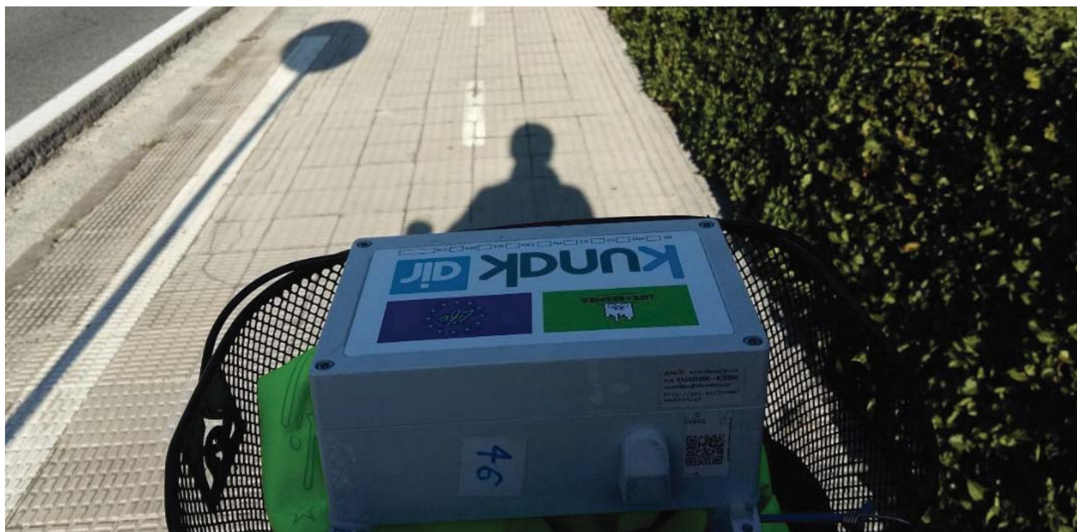
Figura 1. Analizador en posición típica en la cesta de una bicicleta, circulando por un carril bici.
