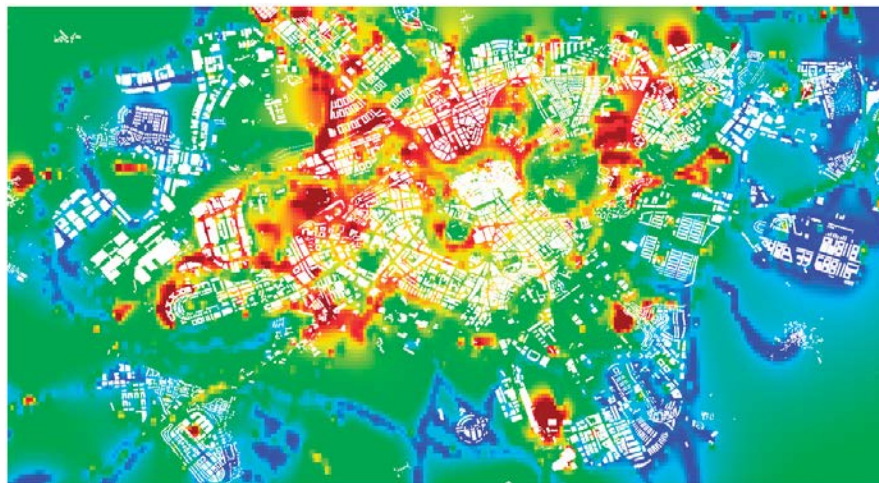
Figura 11. Concentración de CO. Los niveles más altos -rojo- corresponden a la zona de estancamiento del aire junto al talud NW de la ciudad, mientras que los barrios residenciales de las afueras tienen concentraciones más bajas -azul-.
