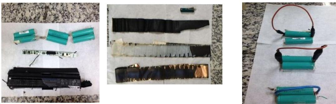
**Figura 10.** Bateria DELL após abertura (A); Composição da bateria íon-Li (DELL) (B); Processo de descarregamento da bateria (C).
