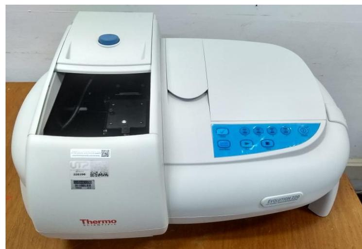
Figura 12 Espectrofotómetro UV-VIS
