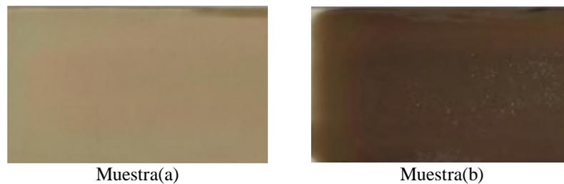
Figura 29 Depósito de películas de 2 y 10 capas respectivamente en las instalaciones de la UTP
