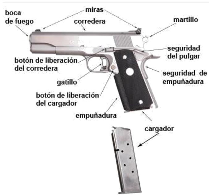
*Figura 13. Partes de arma tipo semiautomática.*
