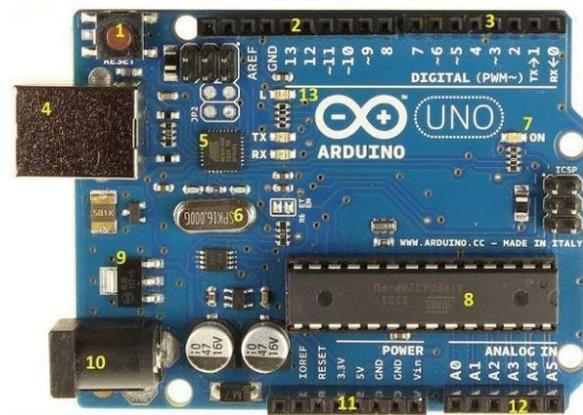
*Figura 10. Placa Arduino genuino uno.*
