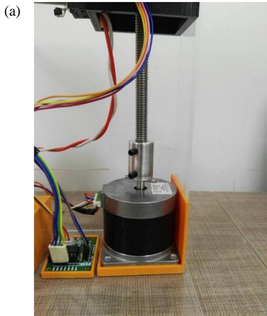
*Figura 27a. Motor paso a paso unido al tornillo Sin fin por medio del buje.*
