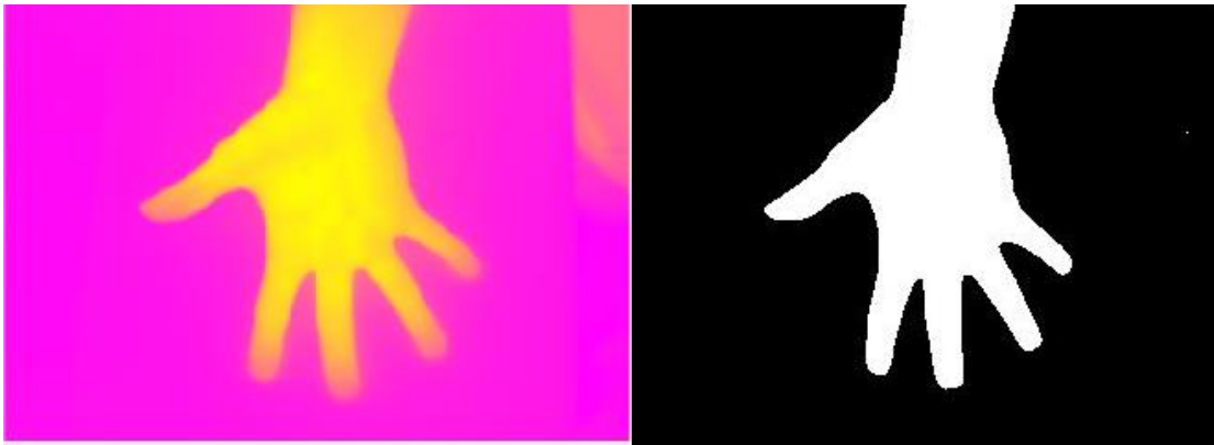
Ilustración 18. Imagen inicialmente leída y posteriormente binarizada.
