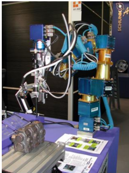
Figura 2.4 : Protótipo do sistema de inspecção de furos [2]
