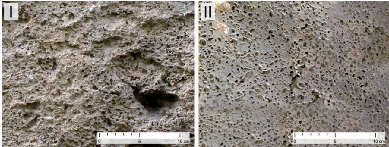
Figura 1. Detalle de piedra travertino, procedente de las canteras de Alfacar-Granada (I) y detalle de piedra artificial porosa que simula el travertino natural (II).
