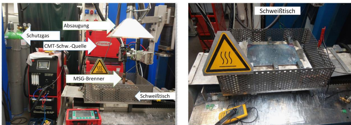
Abb. 3: Versuchsaufbau für MSG-Auftragschweißungen
