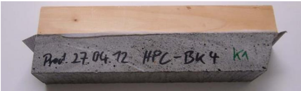
Abb. 6: Elektrisch leitfähig geklebter HBV-Probekörper mit 300 mm geklebter Länge für eine Druck-Schubprüfung nach Lagerung bei definierten Klimazyklen
