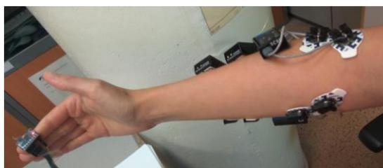
*Figura 5.10 Ejemplo de colocación de los sensores en la adquisición de las señales*<sup>39</sup>
