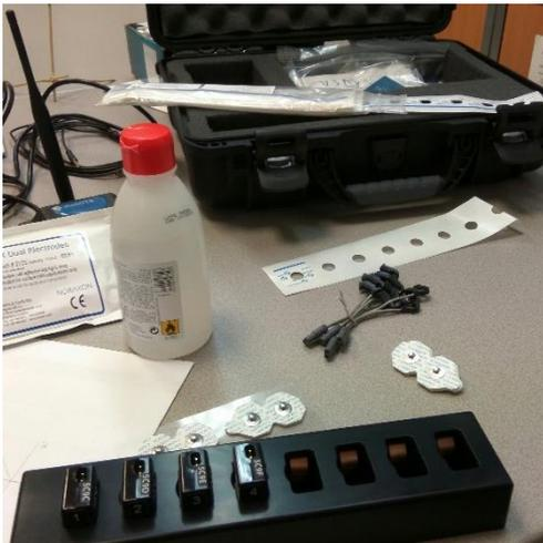
Figura 5.4 Instrumentación necesaria para la medición de señales EMG <sup>32</sup>
