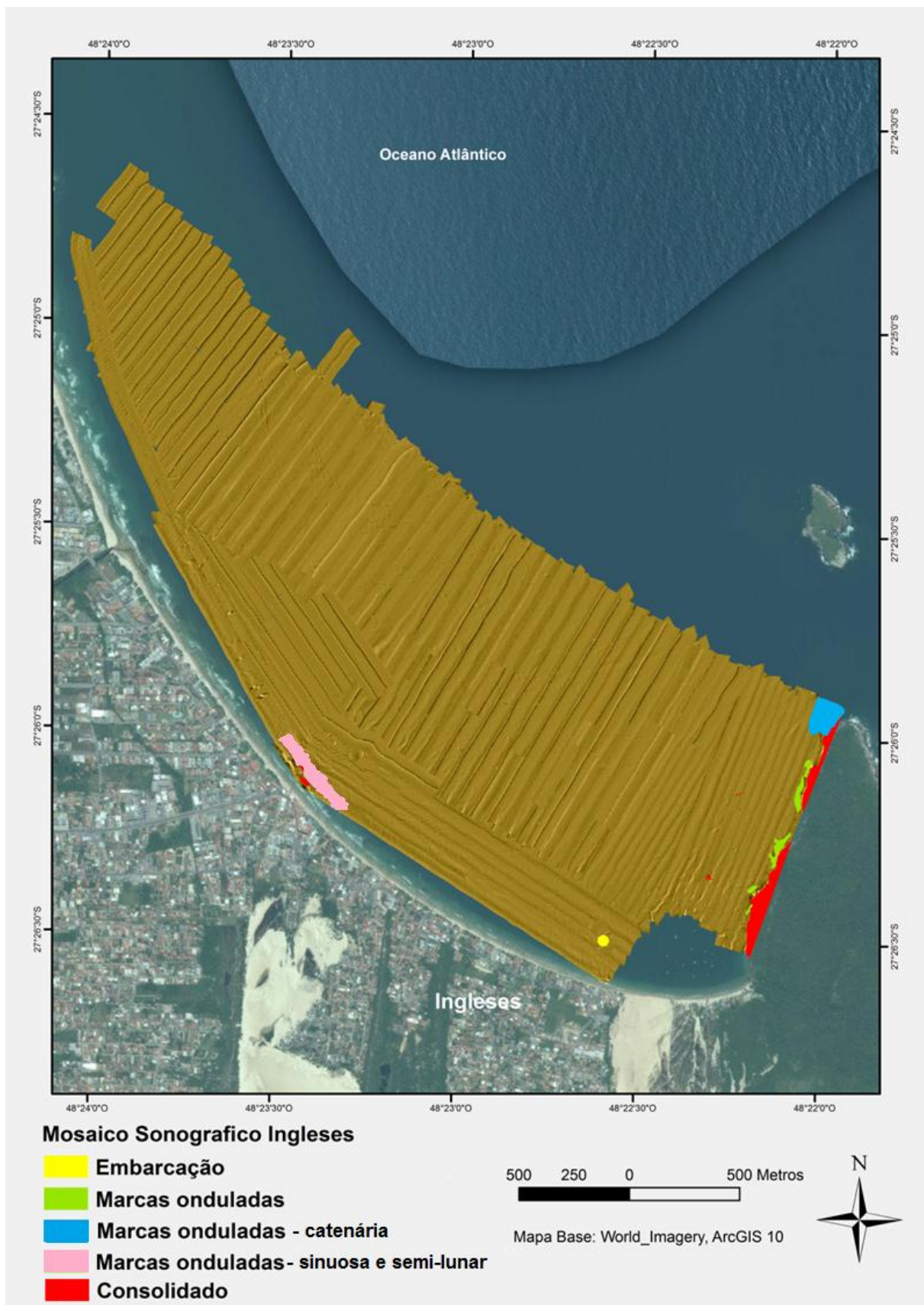
Figura 24 - Mosaico sonográfico dos Ingleses com a identificação das feições encontradas e de um naufrágio. Imagem de satélite de fundo fonte: Google Earth 2015.
