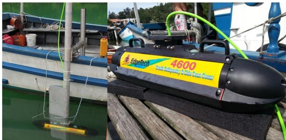
Figura 16 - À direita interferômetro Edgetech 4600 e a esquerda equipamento instalado na embarcação. Fonte: acervo fotográfico LOC (Laboratório de Oceanografia Costeira).
