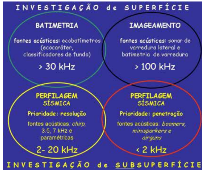
Figura 5 - Comparação das frequências acústicas e suas aplicações, fonte SOUZA (2006). O equipamento utilizado neste trabalho é caracterizado como de investigação de superfície, mais precisamente de imageamento.
