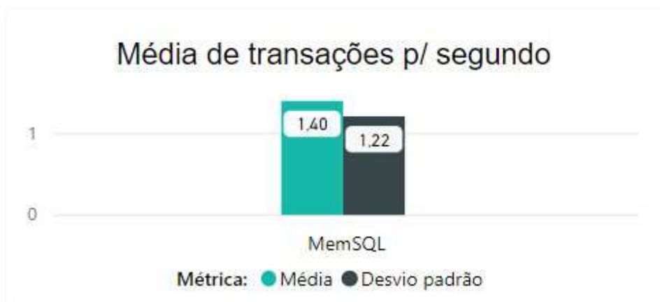
Figura 10 – Média de transações por segundo obtida no benchmark TPC-H ao decorrer do teste para o produto MemSQL
