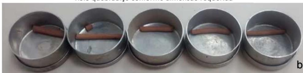
5 amostras de solo para determinar a umidade no limite de plasticidade
