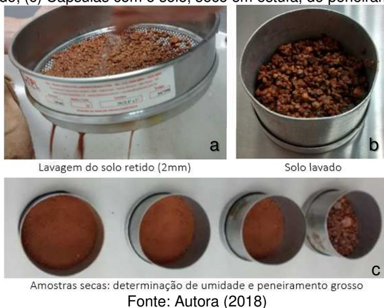
O peneiramento grosso foi obtido passando-se o material seco retido na peneira de 2 mm, nas peneiras de abertura 50 mm, 38 mm, 25 mm, 19 mm, 9,5 mm
