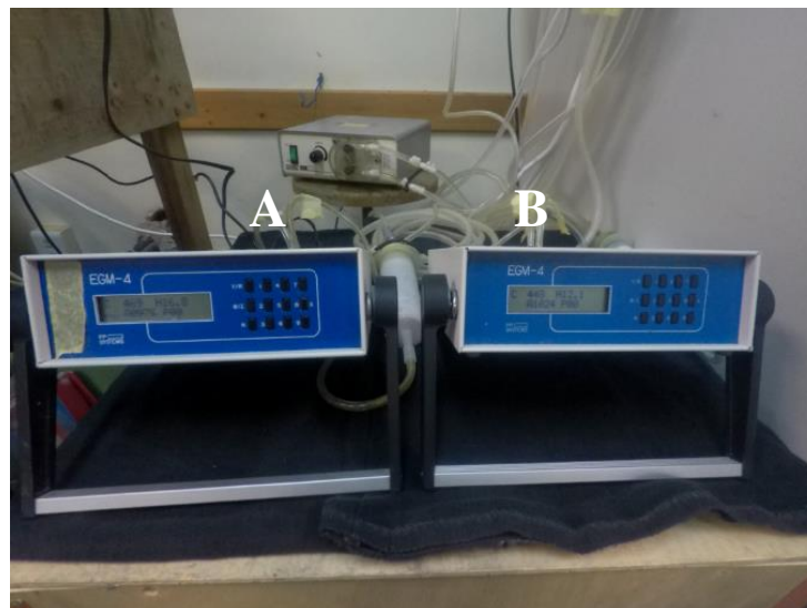
Figura 11 - Sistema IRGA (A- IRGA EGM-4, PP Systems, Reino Unido CO2 água) e (B- IRGA EGM-4, PP Systems, Reino Unido, CO2 ar)
