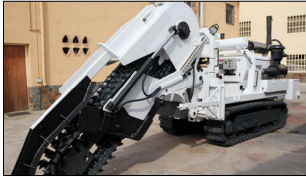
Figura 2.27 - Máquina valetadeira com corrente dentada utilizada no método mini-vala
