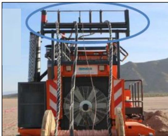
Figura 2.20 - Detalhe da separação dos cabos (organização dos cabos que vem da máquina wrapping )
