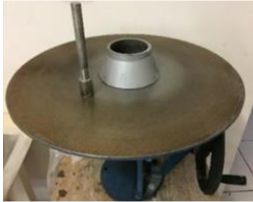
Figura 8 - Aparelhagem para ensaio de consistência flow table .
