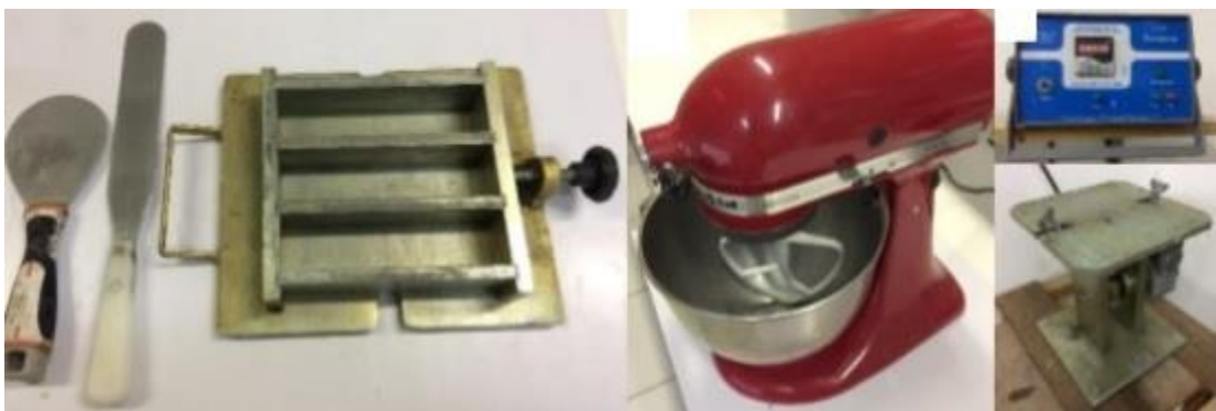
Figura 9 - Aparelhagem para moldagem dos corpos de prova.
