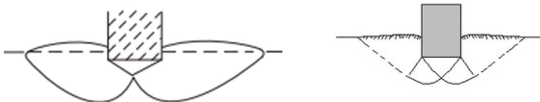
Figura 14 - Modelos de ruptura: geral (esq) e por puncionamento (dir).
