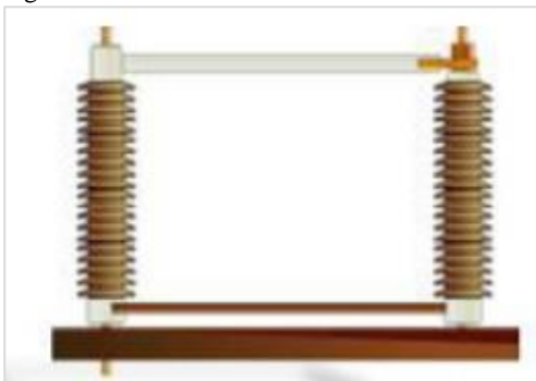
Figura 17 - Seccionadora de abertura lateral
