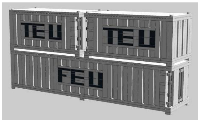
Figura 3. Contentores de Unidade Equivalente de 20 pés, (TEU) e de 40 pés (FEU)
