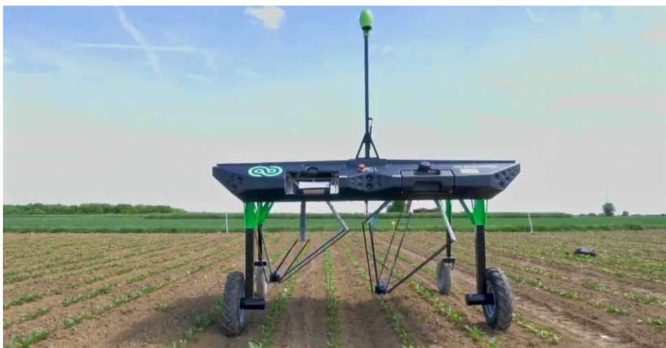
Der Ecorobotix ist ein «autonomer» Roboter, der in Zukunft auch Unkräuter in den Reihen bekämpfen soll.
