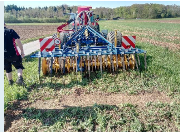
Abb. 43: Arbeit der Federzinkenegge Saphir. Senarclens VD, 20.04.2018
