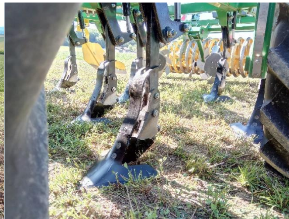
Abb. 38: Seine breiten Zinken überlappen sich genug, sodass die ganze Luzerne regelmässig skalpiert wird. Senarclens VD, 20.08.2018.
