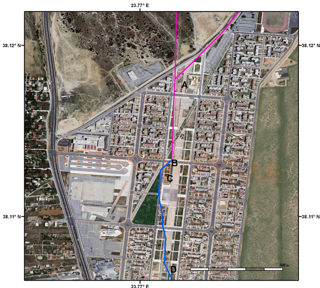
Fig. 4. Olympic Village: channels supplying water from springs converge at point A; BC and CD are the projections on the ground of the inclined gallery and the northern part of the Hadrianic tunnel respectively. Εικ. 4. Ολυμπιακό Χωριό: κανάλια μεταφοράς νερού από πηγές συγκλίνουν στο σημείο A. BC και CD είναι οι προβολές στην επιφάνεια της κεκλιμένης γαλαρίας και του βόρειου τμήματος της σήραγγας του Αδριανείου αντίστοιχα.
